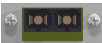
cavo in fibra ottica (SC-Duplex)
