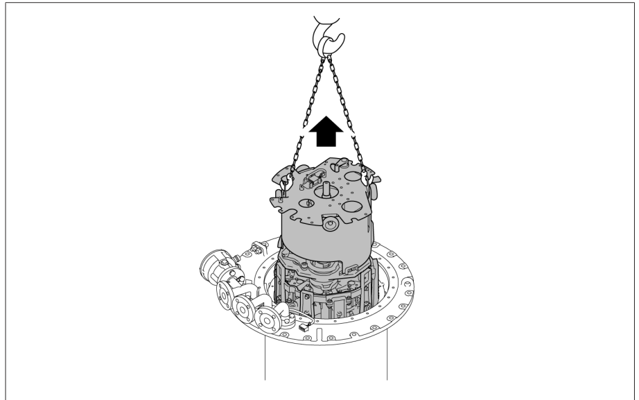
插图 64: 吊出切换开关芯子
