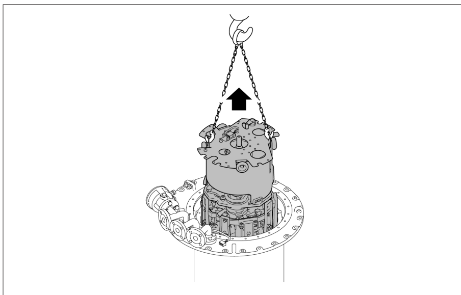
插图 127: 吊出切换开关芯子
