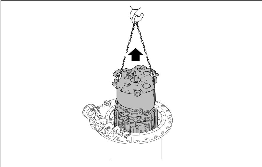
تصویر 170: برداشتن دایورتر سوئیچ یدکی
