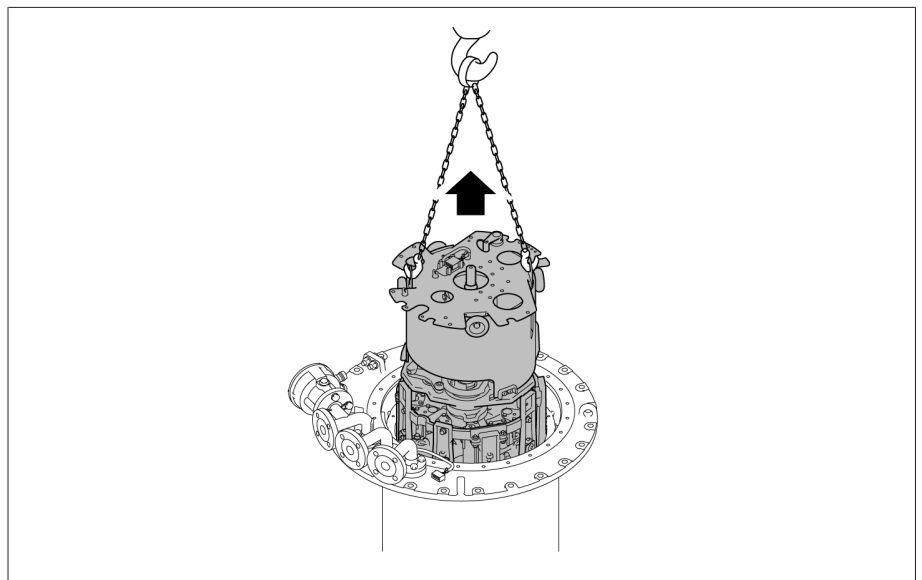
Figura 64: Extracción del cuerpo insertable del ruptor
